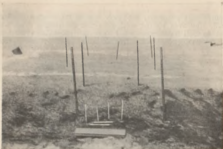
Фиг. 5. Поверхность опытной площадки с разной степенью запыления угольной пылью. Хорошо заметен разный характер таяния фирна при различной интенсивности запыления.
