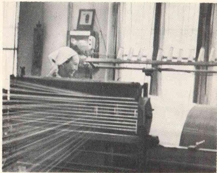
Приготовительный цех. На сновальной машине СЛ140Х-1 работает сновальщица Г. Кулушова.
