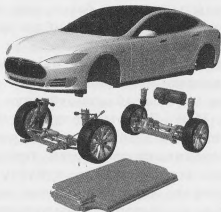
Tesla'нын Model S седаны. Электр мотору (арм жагына жакын) жана батареясы (астында). ©Tesla Motors
